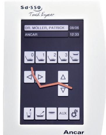
Im Technik-Modus gelangen Sie in die Fenster zur technischen Konfiguration des Stuhls und der Instrumente mit den erweiterten Einstellungen und Parametern.
