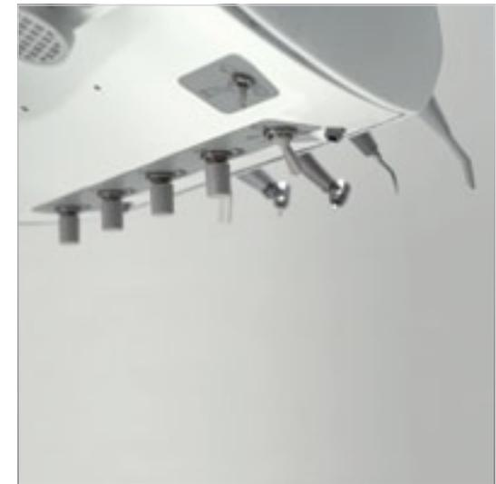
Régulation individuelle de l'eau et sélecteur de vitesse du micromoteur (M40) à 4000 tr/min (partielle) et à 40.000 tr/min (complète).
